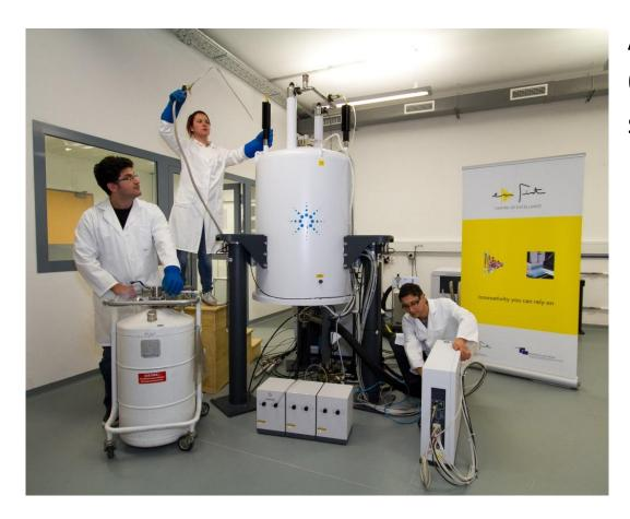
Agilent technologies DD2 600 MHz NMR spectrometer
