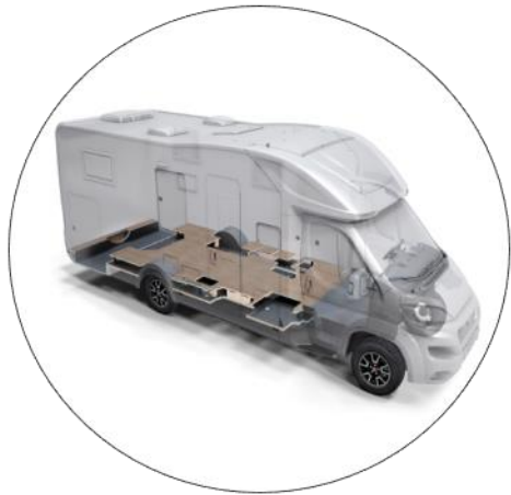
Koncept dvojnega poda za skrite električne inštalacije
