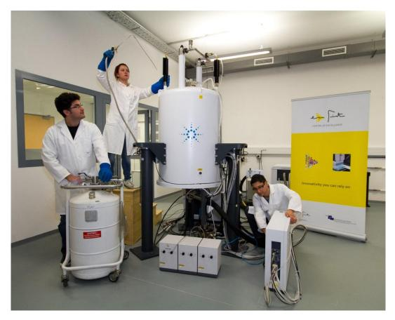
Agilent technologies DD2 600 MHz NMR spectrometer
